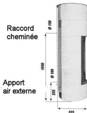
Les poêles à bois de type 1 décrits dans ce manuel sont certifiés selon la norme DIN EN 13240. Les poêles à bois de ce type peuvent être reliés à des cheminées à occupation multiple, dans la mesure où les dimensions de la cheminée le permettent. La norme DIN 4705, partie 3 est à respecter.
