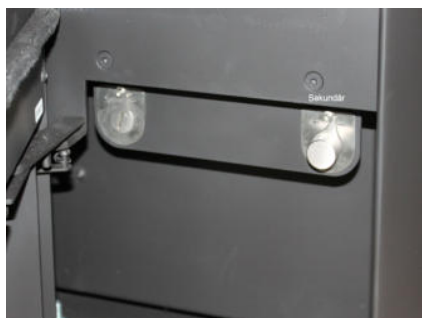
Luftschieber Position in NWL-Einstellung Primärluft (geschlossen)
