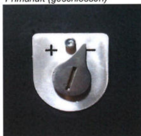
Luftschieber Position in NWL-Einstellung Primärluft (geschlossen)
